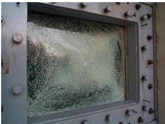
Bild 3: Glasbruch durch Explosionsbelastung
